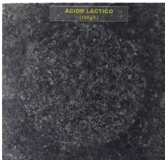
Figura 6 – Muestra “Granito Preto São Gabriel” (LMPC n.º 647-22) - superficie pulida, con blanqueamiento moderado en la zona de contacto, después de la exposición a ácido láctico (100 g/L) durante 24 h.
