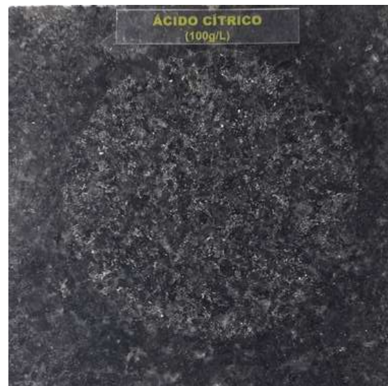
Figura 5 – Muestra “Granito Preto São Gabriel” (LMPC n.º 647-22)-superficie pulida, con blanqueamiento moderado en la zona de contacto, después de la exposición a ácido cítrico (100 g/L) durante 24 h.
