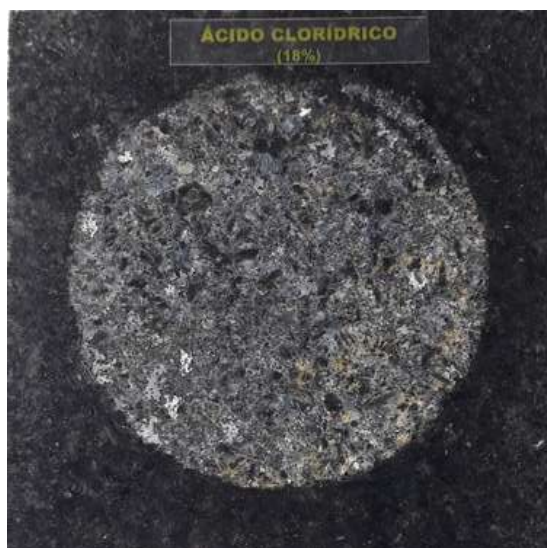
Figura 9 – Muestra “Granito Preto São Gabriel” (LMPC n.º 647-22)-superficie pulida, con blanqueamiento fuerte en la zona de contacto, después de la exposición a ácido clorhídrico (18%) durante 96 h.
