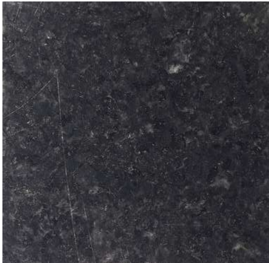
Figura 11 – Muestra “Granito Preto São Gabriel” (LMPC n.º 647-22) – superficie pulida. Muestra referencia, no sujeto a los causadores de manchas.
