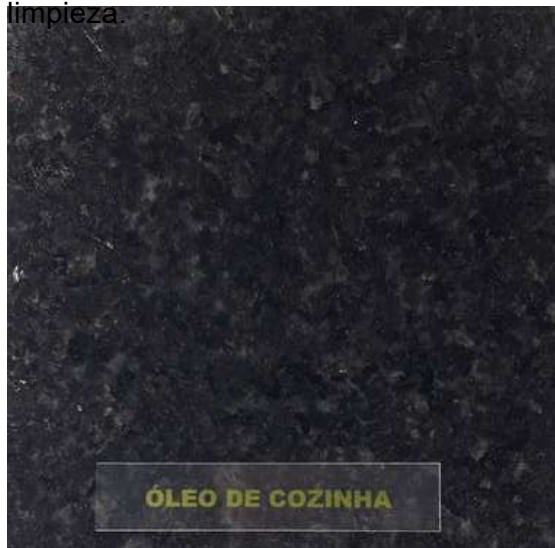
Figura 17 – Muestra “Granito Preto São Gabriel” (LMPC n.º 647-22) – superficie pulida, después de la exposición al aceite de soja y una operación de limpieza.
