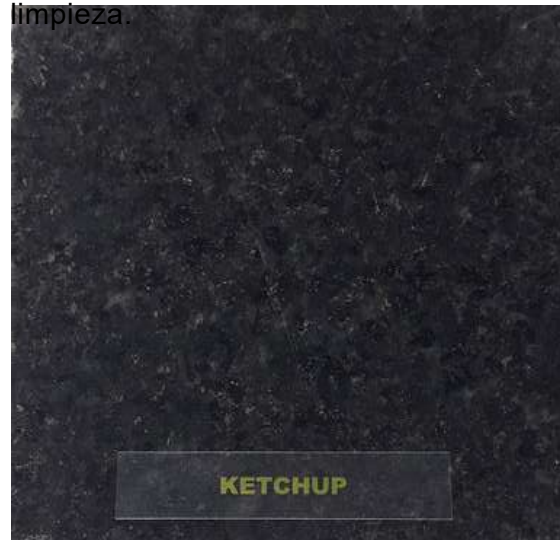
Figura 14 – Muestra “Granito Preto São Gabriel” (LMPC n.º 647-22) – superficie pulida, después de la exposición a la salsa de tomate y una operación de limpieza.
