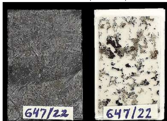
Figura 1 – Fragmento seleccionado para análisis petrográfico y su respectiva sección delgada. Dimensiones de la lámina de vidrio: 2,5 cm x 4,0 cm.
