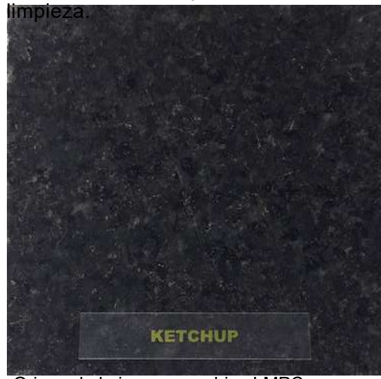
Figura 14 – Muestra “Granito Preto São Gabriel” (LMPC n.º 647-22) – superficie pulida, después de la exposición a la salsa de tomate y una operación de limpieza.
