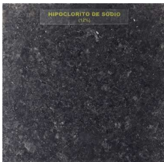
Figura 4 – Muestra “Granito Preto São Gabriel” (LMPC n.º 647-22)-superficie pulida, con blanqueamiento débil en la zona de contacto, después de la exposición a la solución de hipoclorito de sodio (12%) durante 24 h.
