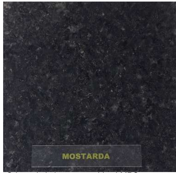
Figura 16 – Muestra “Granito Preto São Gabriel” (LMPC n.º 647-22) – superficie pulida, después de la exposición a la mostaza y una operación de limpieza.
